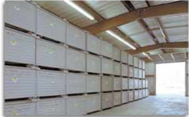
Les déchets de la gare de triage de Thornton sont stockés dans des conteneurs normalisés de l'installation de stockage du Bureau aux laboratoires d'EACL, à Chalk River.
