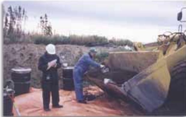
Mesure des radiations gamma dans les déchets au site de stockage provisoire de Tulita, dans les Territoires du Nord-Ouest.
